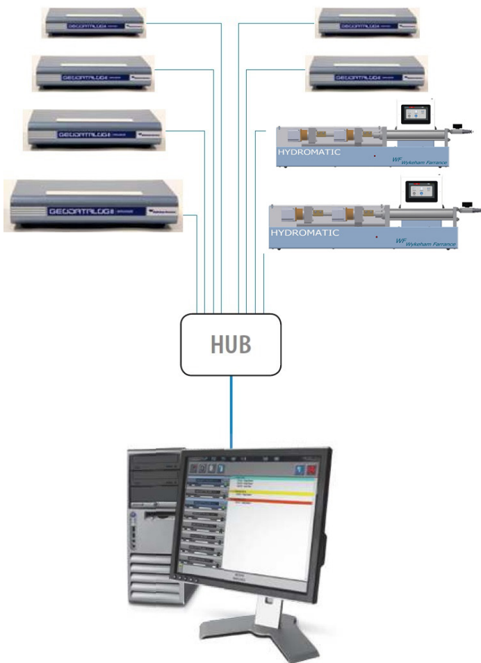
Sistema modulare nella configurazione triassiale GEODATALOG 8 ed HYDROMATIC collegate in rete.
